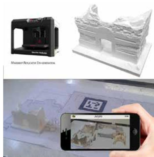
Fig. 10. Sperimentazione della realtà aumentata relativa al caso studio di Villa Adriana a Tivoli. Il modello 3d dell'Esedra dell'area di Palazzo stampato tramite stampante 3d e posto su una planimetria. Tramite l'applicazione Junao ed un Codice QR è possibile visualizzare l'intero modello 3d 'texturizzato' dell'area.
